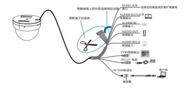
【说明】部分型号支持POE供电,即网口供电,网口连接POE路由后无需连接其他电源。 尾线接口请根据具体型号支持为准,上图所示为接口最全的型号。 线缆识别请参考附录部分。
