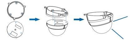
3. 参照前面吸顶安装步骤安装即可完成斜面安装。
