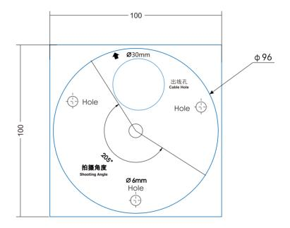
【说明】此设备的水平旋转方向为205°,所以在进行安装贴纸时,用户期望监控的方向应与拍摄 角度方向一致。
